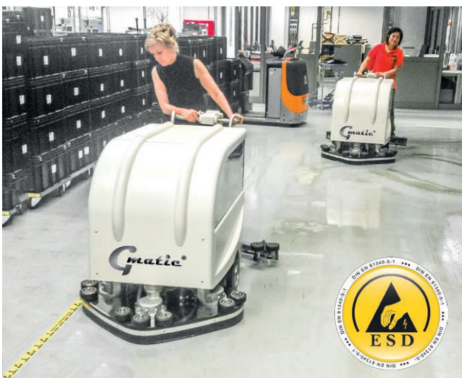
Scheuersaugmaschine Gmatic® 100 BTXS 95 in elektrisch ableitfähiger ESD-Version
